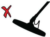
Falscher Winkel der Suchspule zum Boden
