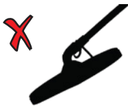
Falscher Winkel der Suchspule zum Boden
