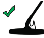
Richtiger Winkel der Suchspule zum Boden
