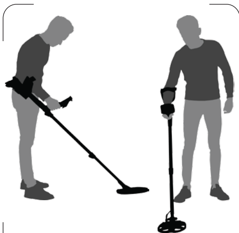
Länge des Gestänges ist falsch
